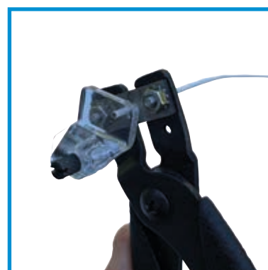
Butée de longueur de dénudage réglable (pour des longueurs de dénudage précises)
