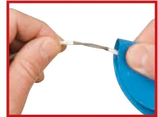
Greifen Sie mit dem Isolationsrestentferner IDEAL Gripper™ (separat erhältlich) die zu entfernende Isolierung und ziehen Sie sie ab.
