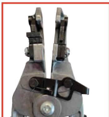
„Short-Stop“-Verriegelung schützt Leitungslitzen durch Begrenzung des Abisolierhubs auf **4 mm** (5/32 Zoll) und hält die Isolationsreste zurück, bis die Leitung weiterbearbeitet wird.
