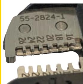
Gerade Messer bestehen aus zwei Platten, die eine Platte mit den abgesetzten und auf die Isolierung abgestimmten Löchern halten. Gegenüber befindet sich eine Platte mit der Schneidbohrung, die an den Leiterdurchmesser angepasst und von Typ und Stärke der Isolierung abhängig ist.
