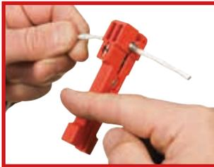
Drehen Sie die Abisolierzange vom Körper weg nach unten. Für gewöhnlich reichen 2 bis 3 Umdrehungen aus, um einen vollständigen Schnitt in die Isolierung einzubringen
