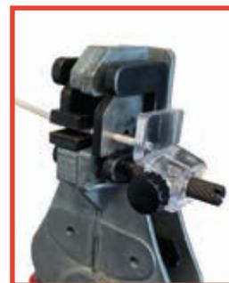
Transparenter Längenanschlag gewährleistet eine einheitliche Abisolierlänge.
