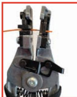
„Short-Stop“-Verriegelung schützt Leitungslitzen durch Begrenzung des Abisolierhubs auf **4 mm** (5/32 Zoll) und hält die Isolationsreste zurück, bis die Leitung weiterbearbeitet wird.
