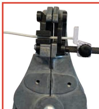
Transparenter Längenanschlag gewährleistet eine einheitliche Abisolierlänge.
