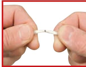
Ziehen Sie das Kabel aus der Zange und biegen Sie es entlang der Schnittlinie, so dass sich die Isolierung löst
