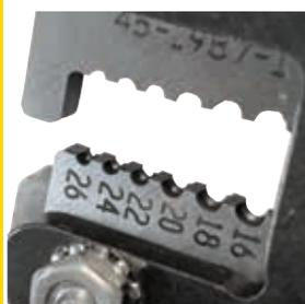
Matrizenmesser besitzen abgesetzte, auf die Isolierung abgestimmte Löcher, sowie eine Schneidbohrung, die an den Leiterdurchmesser angepasst ist und von Typ und Stärke der Isolierung abhängig ist.
