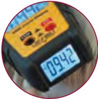
**Durch das patentierte TightSight™ Display mit Hintergrundbeleuchtung** müssen die Leiter nicht mehr umständlich gebogen oder verdreht werden und Sie müssen nicht mehr versuchen, den Kopf möglichst weit in das Verteilerfeld hineinzustecken. Stattdessen erlaubt diese Ergebnisanzeige an der Unterseite des Multimeters das bequeme Ablesen der Messergebnisse.
